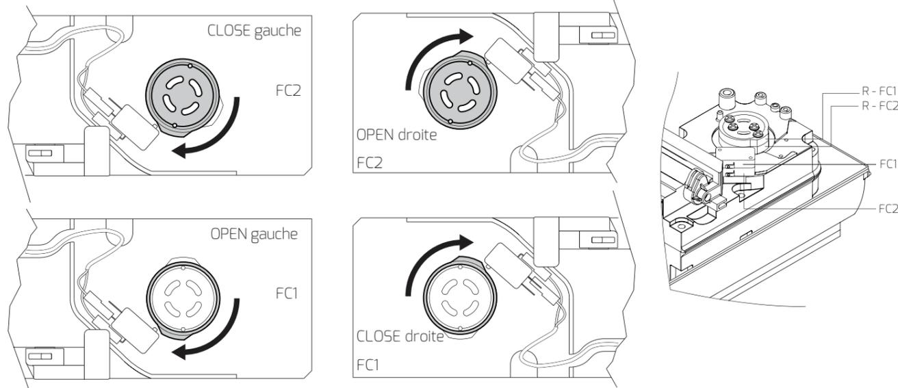
Moteur à mi-course, la 1<sup>ère</sup> impulsion est une ouverture. Le moteur M1 est le 1<sup>er</sup> à s'ouvrir.
